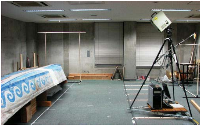
図3 レールスライド機構を用いた立体形状測定装置
