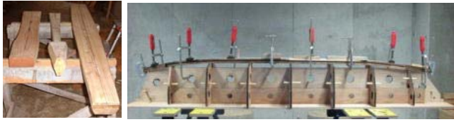
図19 従来の竜骨部材(左)と成型による竜骨(右)
