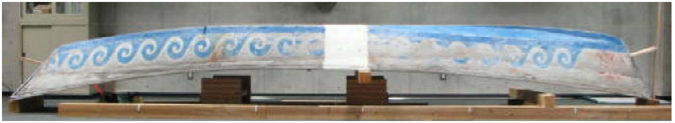
図2 測定した伝統木造船アイノコ(上が船底, 右が船首)
