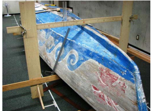
図8 スケールを用いたアイノコの実測
