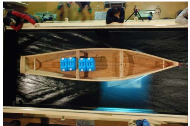
図13 回流水槽試験
