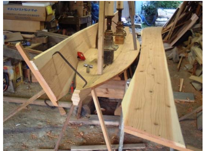
図12 製作の過程（底板と舷側板の接合）
