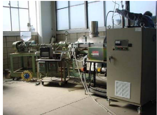
写真1 連続式高温高圧処理装置
