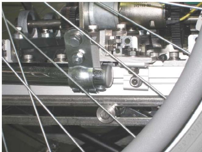
図6 車いすへの架台の取付け状況
