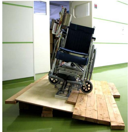
図12 昇降装置の安定性試験
