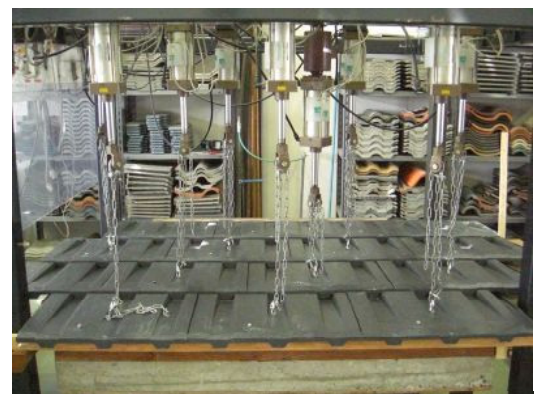
図7 耐風ユニバーサル試験装置による耐風引張試験
