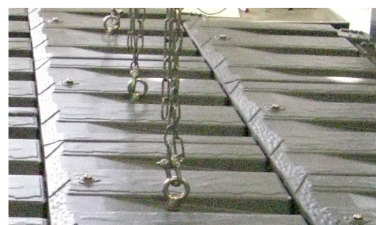
図8 同上の耐風引張試験(シラス瓦 石娘S-24)
