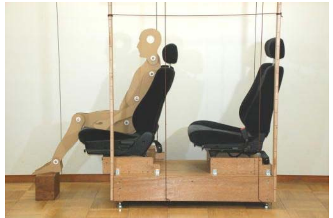
図1 自動車乗降性評価用モックアップ
