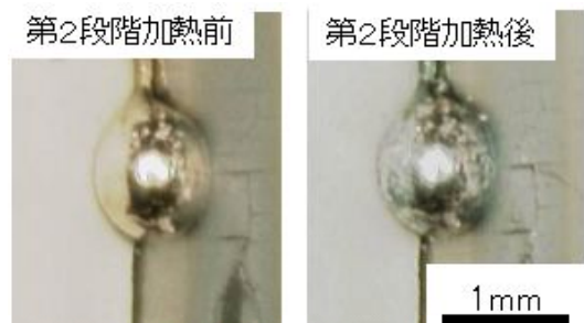
図5 第2段階の加熱前後における第1段階のろう材外観
