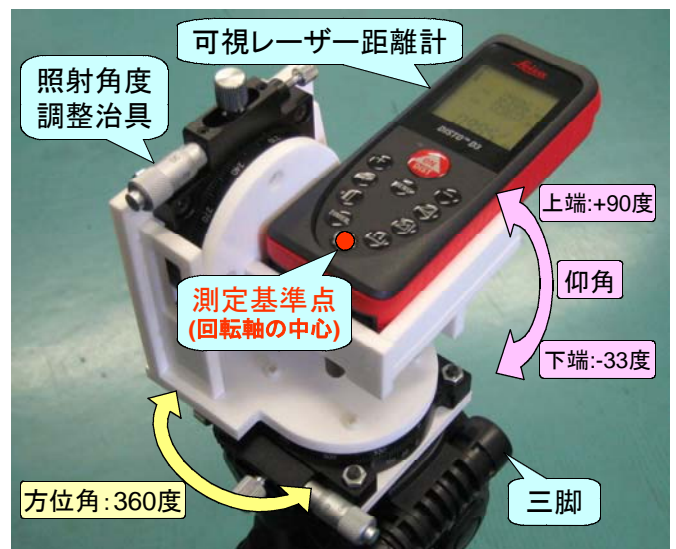
図5 可視レーザー距離計を取り付けた照射角度調整治具
