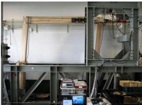
図11 門形フレームの水平加力試験状況
