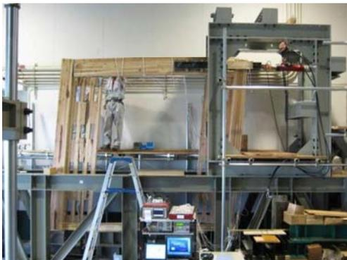
図17 耐力壁の面内せん断試験状況
