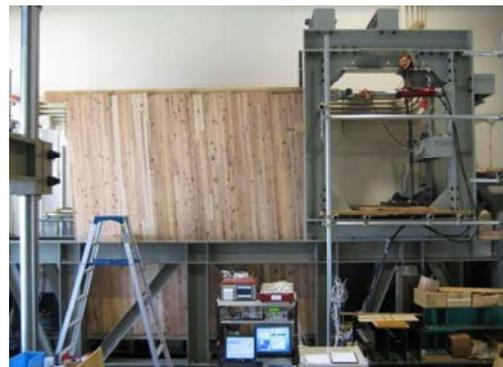
図14 水平構面の面内せん断試験状況
