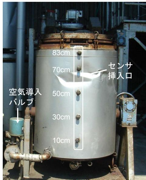
図2 試験炭化炉写真
