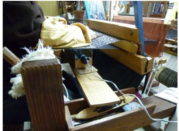
図10 電熱器使用による絣調整
