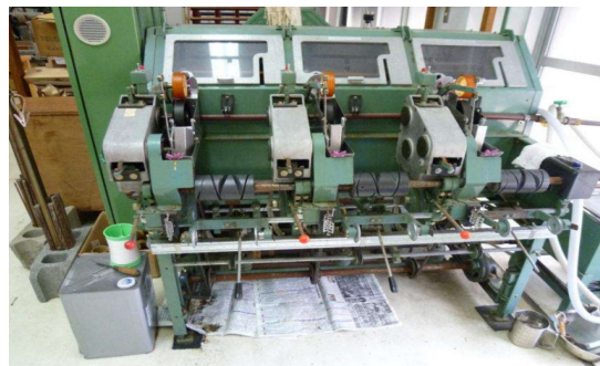
図5 自動乾燥糊付け機(全体)
