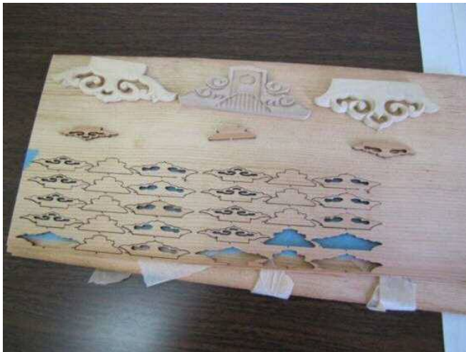
図9 レーザ加工機により切断した宮殿部品の一部
