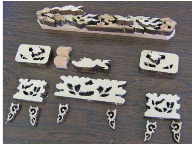
図8 レーザ加工機により切り取られた彫刻部品の一部
