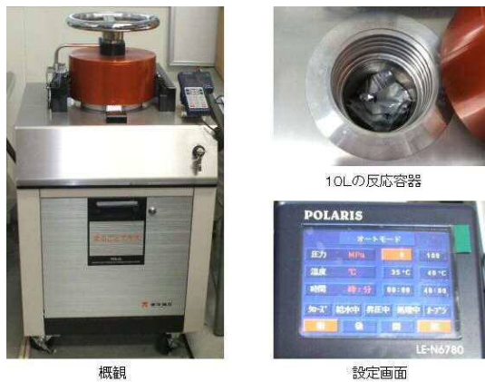
図2 超高压実験装置
