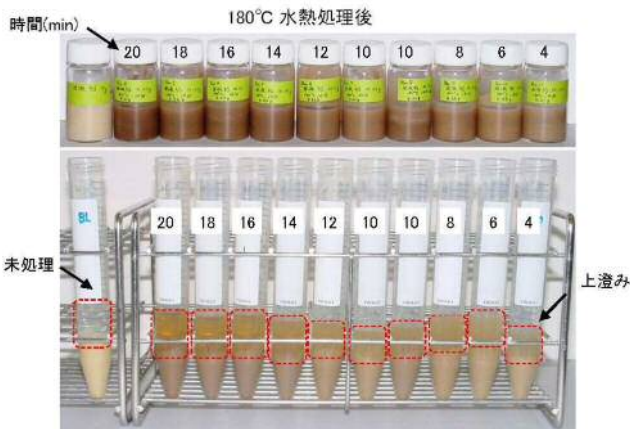
図6 水不溶性画分の水熱処理液（上段）および遠心分離後（下段）の状態
