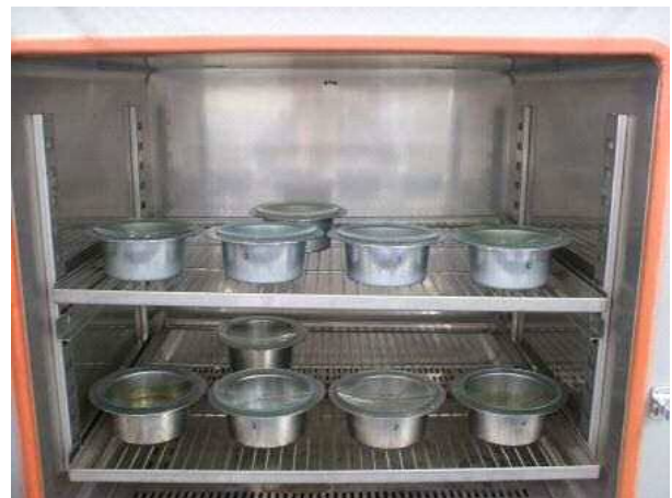
図2 恒温乾燥器に設置した試験容器(金属材料)
