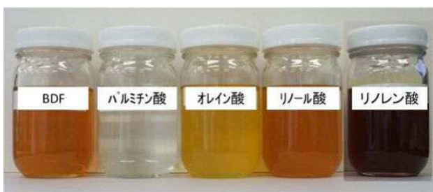
電気亜鉛めっき鋼板 (ボンデ鋼板) 浸漬後 左から BDF, C16, C18:1, C18:2, C18:3
