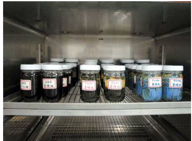
図1 恒温乾燥器に設置した試験容器(ゴム材料)
