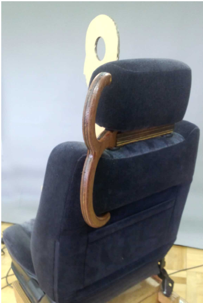
図13 試作品B（ミニバン用、握り棒（縦））
