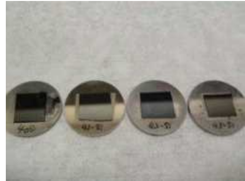
図7 UBMS装置で作製したDLC膜
