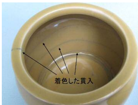
図1 貫入の発生状況
