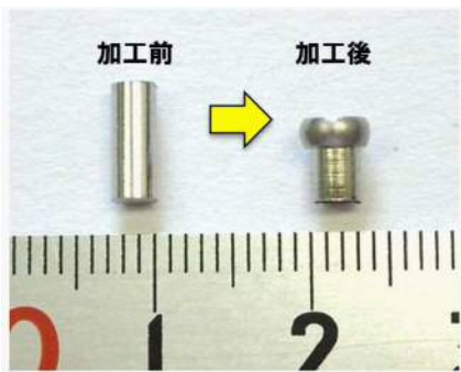
図8 試験片と加工後の成形品 (20℃)
