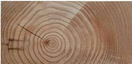
図9 DBT90°C, WBT60°Cで発生した内部割れ
