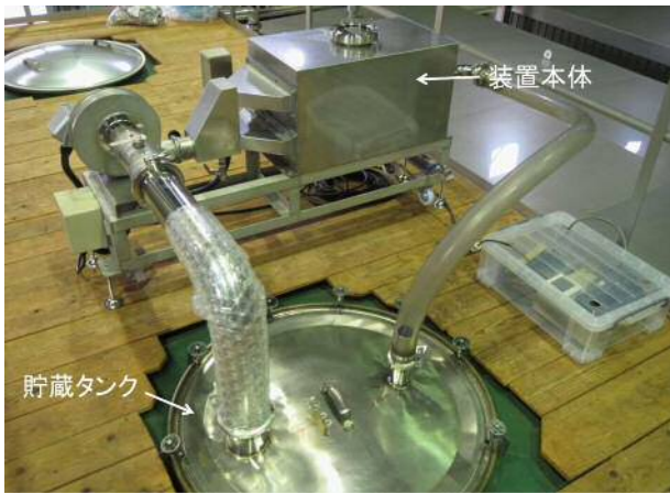
図2 ガス抜き促進装置をタンクに設置した様子
