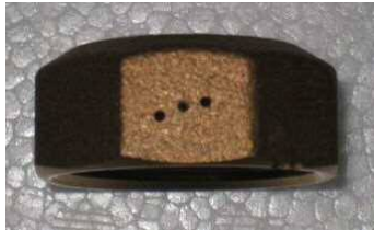
図3 ドリルで貫通穴を開けた検査用サンプル (直径2mmの穴を3個開けた側面の写真)
