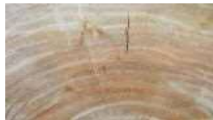
図8 心去り平角材の最も大きな内部割れ
