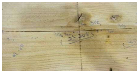
図6 心去り平角材の最も大きな表面割れ
