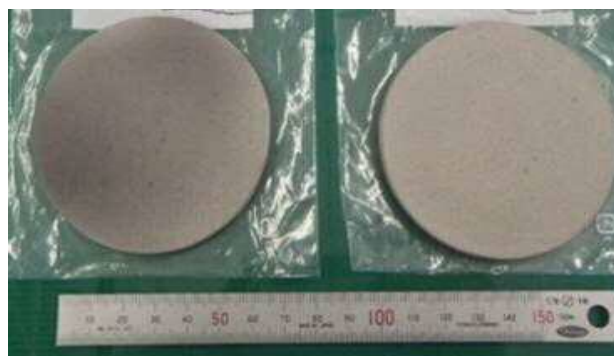
図1 シラスをSPS法で作製した焼結体 （左：相対密度98%，右：94%）
