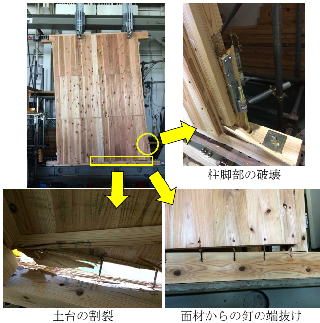
図17 試験後における試験体の様子
