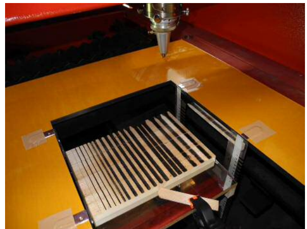
図2 焦点からの距離可変治具
