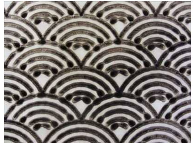
図9 加工始めに過度に出力された型板
