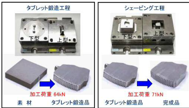
図15 試作パンチと試作結果
