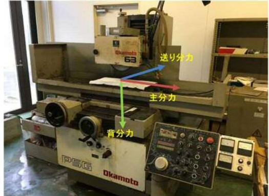
図8 平面研削盤および研削抵抗の方向
