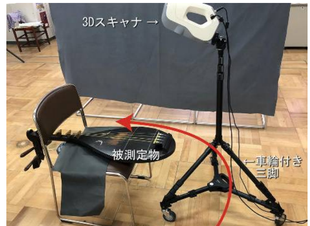
図4 車輪付き三脚による円弧移動
