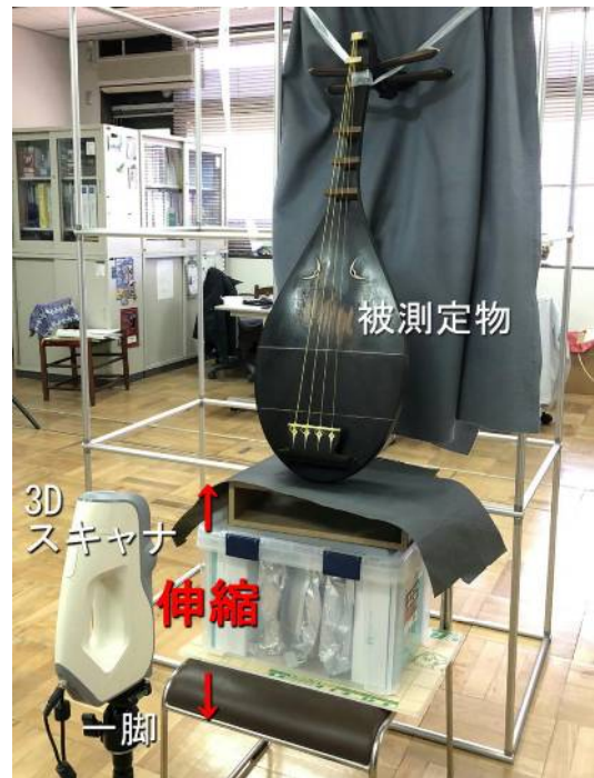
図9 伸縮式一脚による直線移動
