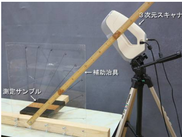
図2 測定サンプルと補助治具
