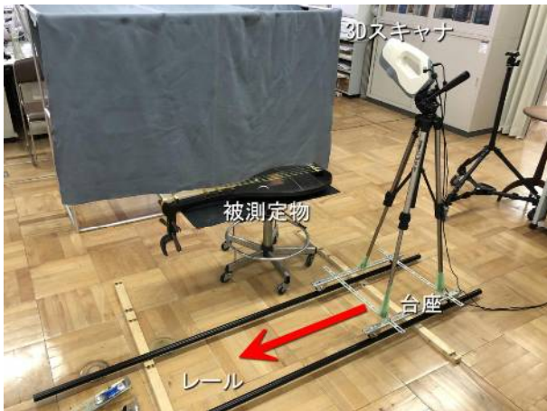
図6 レールによる直線移動
