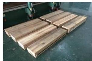
図11 せん断試験体
