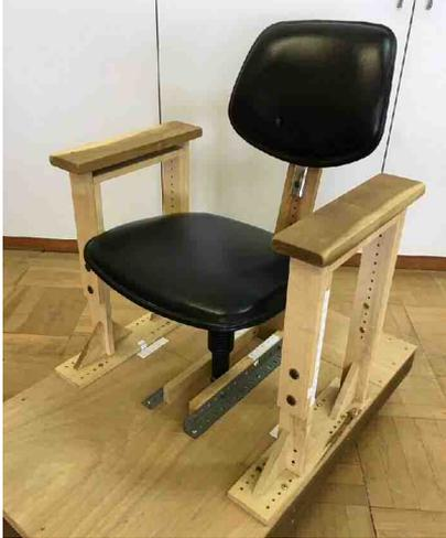
図1 椅子シミュレータ
