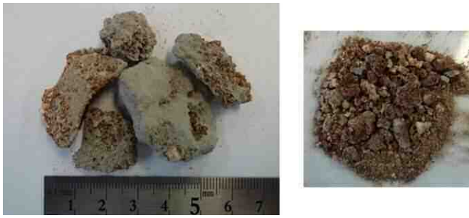
図1 バイオマスボイラーから発生したクリンカ 左：クリンカ 右：クリンカを砕いたもの
