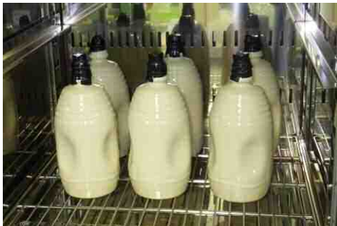
図6 薩摩焼の漏れ試験状況
