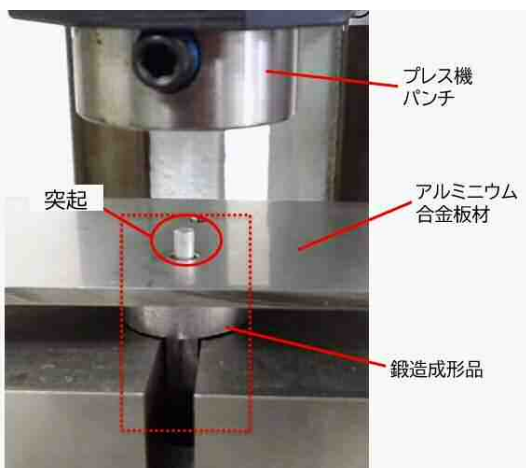
図18 かしめ加工実験の概要
