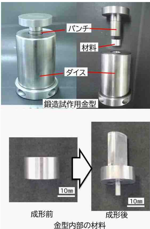
図9 鍛造試作の概要
