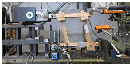
図12 軸組耐力壁の水平荷重試験方法
