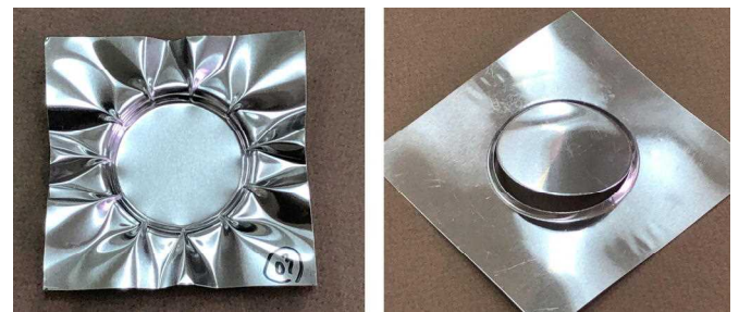
図4 被加工材のしわ(左), 割れ(右)
