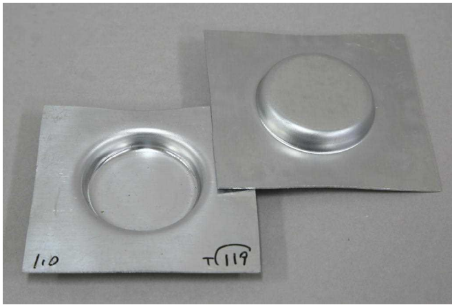
図16 ダイアール3, クリアランス=1.2の成形品
