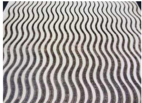
図6 傾斜加工した型板（拡大図）
