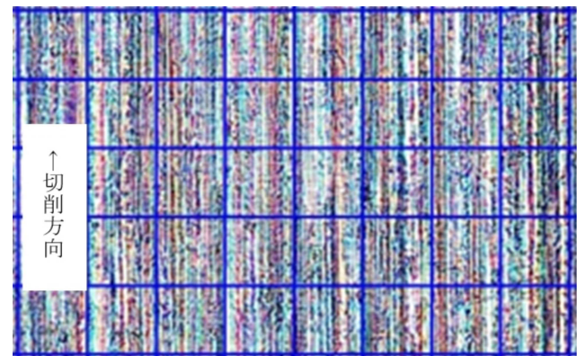
図8 被削材表面の顕微鏡写真(DLCコーティング)
