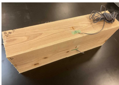
図4 ひずみゲージの貼付状況
