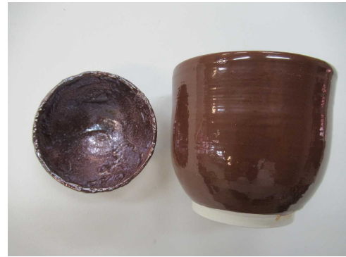
図10 1100℃焼成後の粒度の異なる漂着軽石釉薬 左：粗粉碎（紫ラメ色）、右：微粉碎（茶色）
