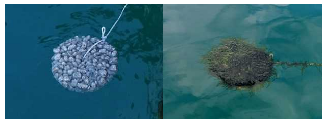
海上敷設直後 37日経過後 図11 漂着軽石ブロックの浮漁礁試験
