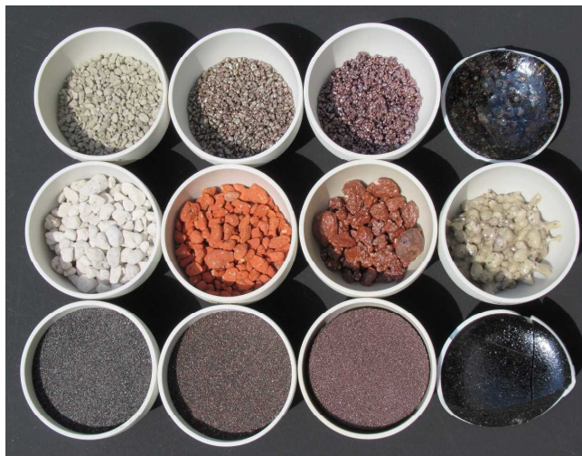
図9 上段：漂着軽石、中段：シラス軽石、下段：桜島火山灰 左から未焼成、1000℃、1100℃、1250℃
