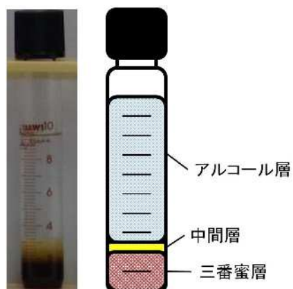
図3 試験管を用いた糖回収試験結果
