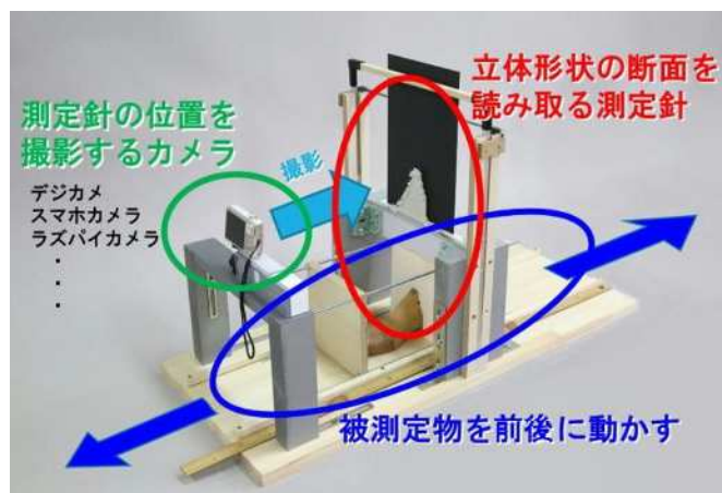
図3 新しく考案した測定器
