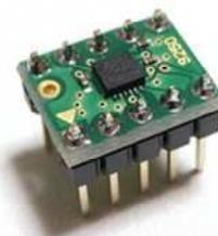
図17 安価加速度センサー例 (MPU-9250)
