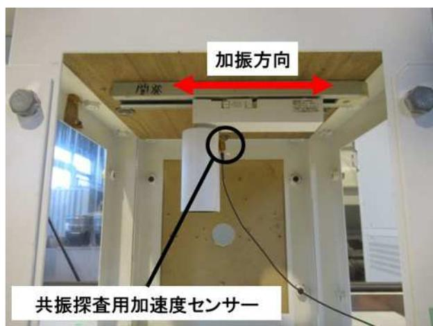
図9 複雑形状の試験体のエリア①共振探査セッティング
