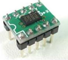
図10 安価加速度センサー例 (ADXL375)
