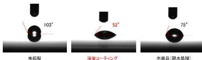
図8 異なる表面状態でのぬれ性（接触角測定）の結果
