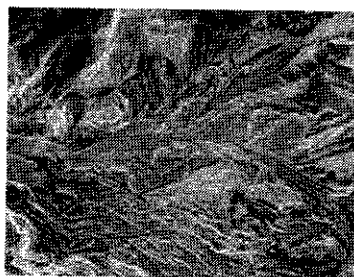
(1,000×0.75)×0.53 図2. 図1A部のフラクトグラフィー(矢印はクラック進行方向)
