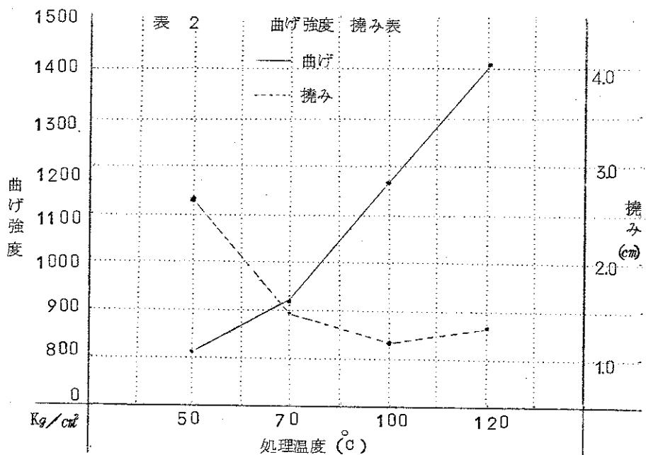
4. 成 果 竹材の温度による材質的な影響は処理温度が高くなるにつれ強度はいずれも、これを比例して上昇する傾向を示し一方物理的な性質は竹破という点から観察すると機械的性質とは反比例の現象を生じ縮み撠みは温度が70°Cあたりを頂点としたそれ以上の上昇になると減少していく。これは材質が高温の為に炭化現象をきたし、もろくなり竹材の特性を維持出来ず硬くはあるが、ねばり及弾力性が失われるであろう。故に竹材の利用を最大効果ならしめるには100°C以下で処理することが望ましいといえよう。
