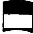
図-2 稈壁厚さの内側半分でも内皮部を削除した試片
