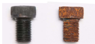
腐食試験前 腐食試験後
