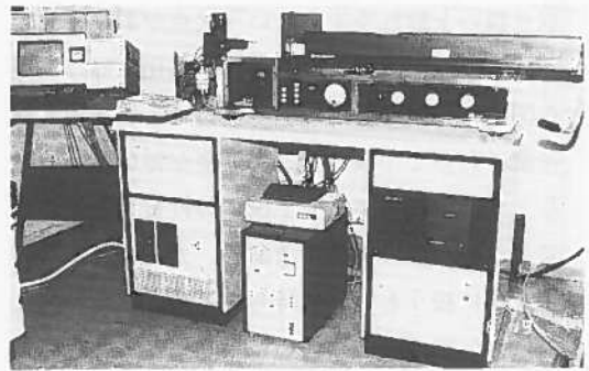
生体細胞自動識別分取装置 (細胞融合装置つき)
