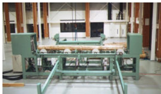
図4 丸太の等級区分装置
