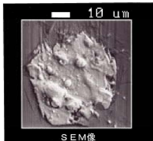
“鉛を含む黄銅材料からCa-Si処理で鉛の分離・除去に成功”
